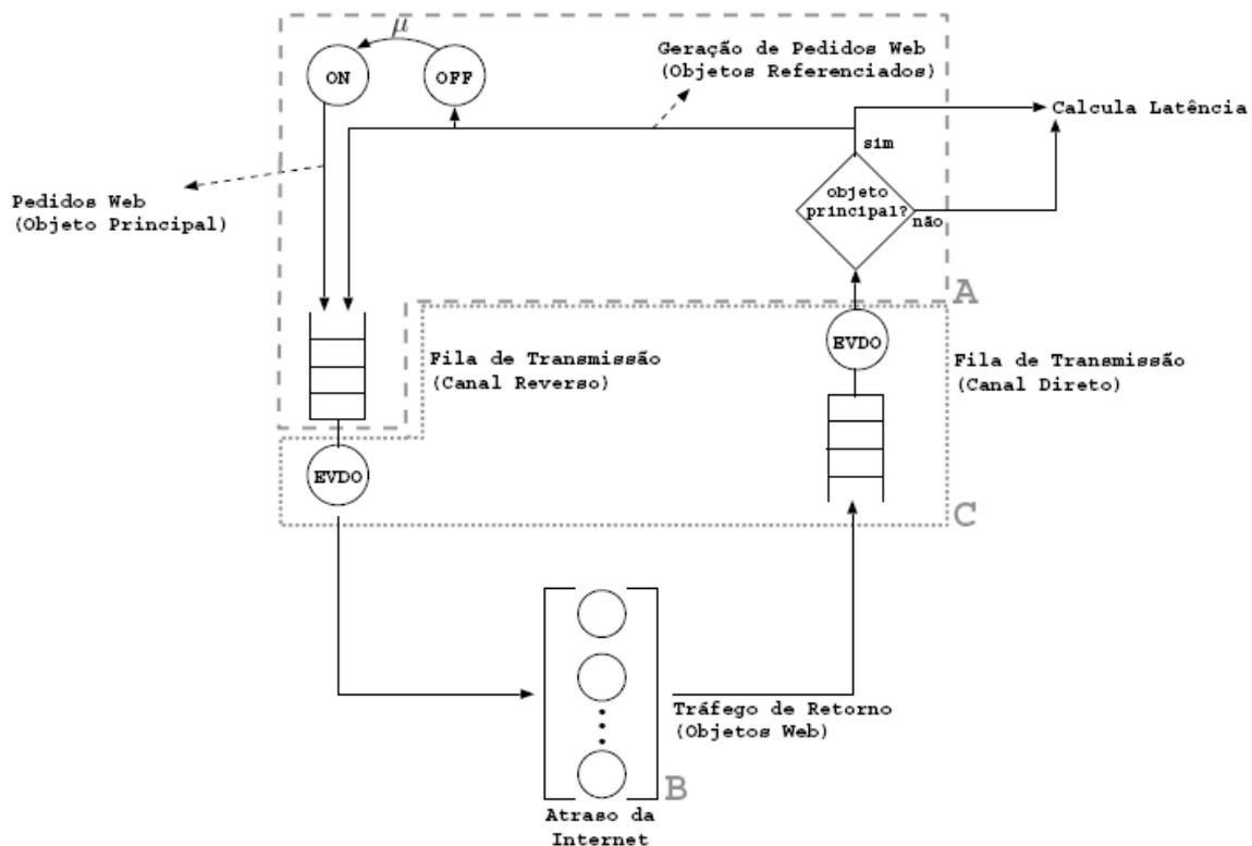
**Figura 2. Visão geral do modelo implementado**
